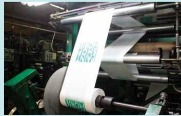
「原反(右下参照)」に印刷をしていく。高速で
