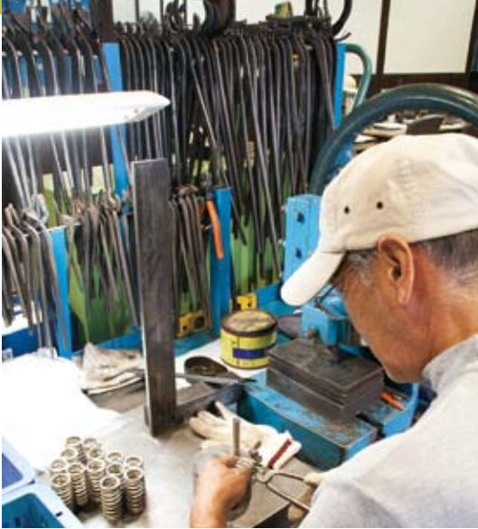
コイルばねの間隔調整を行う梶川さん。目の前には「ハシ」と呼ばれる道具がずらりと並び、それぞれの形態に合わせて使い分ける。ばねの特性を決める重要な作業で、自分の手に合うものと道具はすべて手作り。様々なばねを作る内に、「ハシ」の数も増えていったという。
