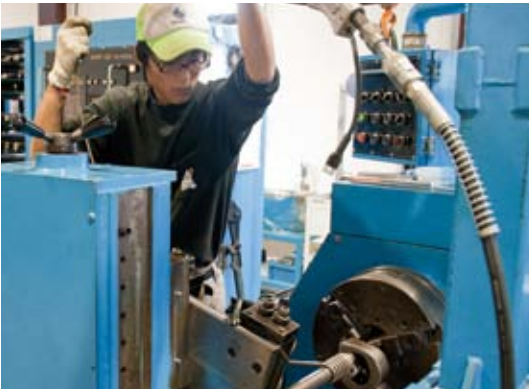
ばねの元となる巻き取り作業。特性に合わせた微妙な調整が要求される。
