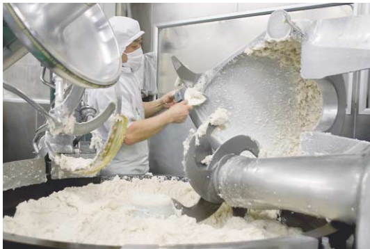
材料を攪拌する機械。生地をなめらかにするため粒の大きさにもムラがないよう、機械に付いた生地を蓋を何度も開け、手作業で落とす。
