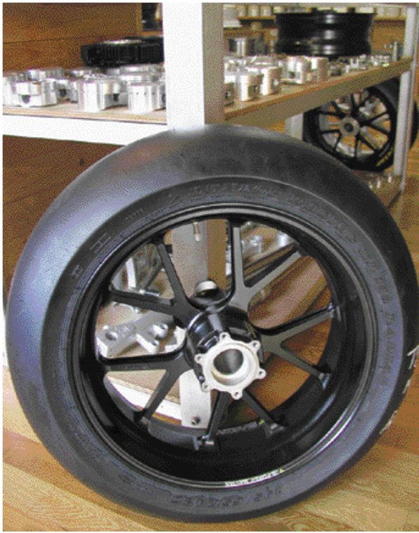
BITO R&Dが開発したマグネシウム鍛造ホイール「マグ鍛」。他にも世界初のチタン製マフラーなど世界トップクラスの技術を誇る製品を次々と発表している。
