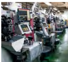
工場内にはさまざまな形状のバネを作り出す機械が並び、社内で開発できるのも大きな強み。
