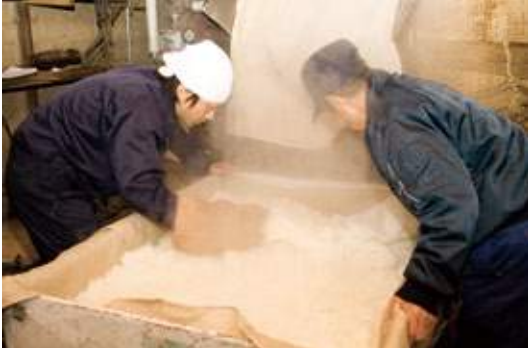
酒造りは11月から始まり、3月頃まで麴造り・蒸し・発酵・寝かし・搾りなどを行う。此の友酒造では、永年使い続ける甕(こしき)で酒を蒸し上げる。「蒸して味が決まる」とも言われる重要な作業。
