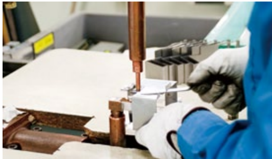
板金加工部門。技能資格者が厚さ3.2mmまでの薄板金属を曲げたり、溶接したりし、厳しい寸法で精密部品を加工する。
