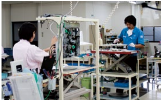
装置組立部門。実際にテスト運転を行い、誤作動がないか、顧客の要望に沿った動きができていないかなど何度もチェックされる。
