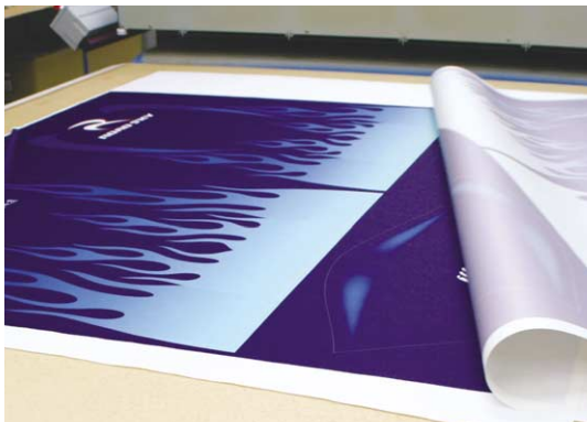
生地に転写されたウェアのデザイン。これを裁断、縫製し、形にする
