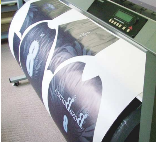
特殊人型インクジェットプリンターから印刷されていくウェアのデザイン
