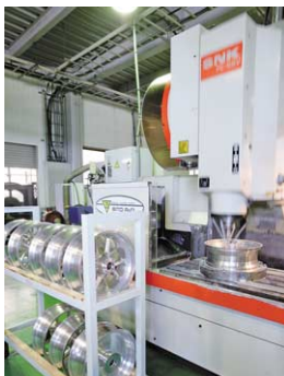
マシーニングセンターによるスポーク部の加工
