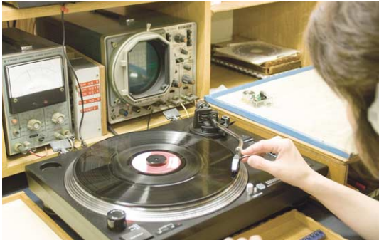
完成したレコード針は、実際にレコードにかけて検査が行われる。周波数や出力、音の響きを約5秒ほどで検査。使用されるレコードは、クラシックかと思いきや「演歌」。演歌のこぶしが音質を調べるのに最適なんだそう。
