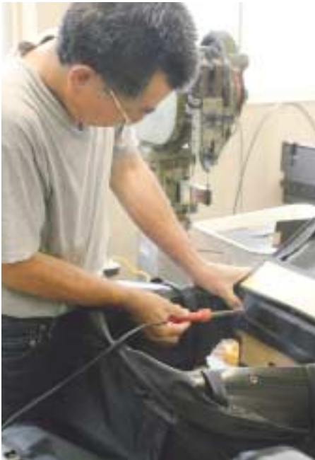
粹入れ・鉸打ちなどの最後の仕上げ作業。
