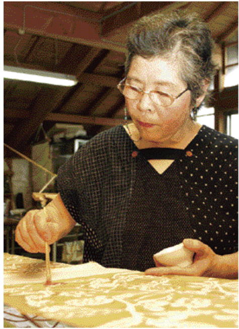
寺口さんの用いる技法は「型染め」。型紙を使って布の上に糊(のり)を置き、防染した部分に図柄を染め抜く。
