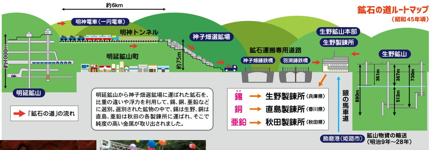
明延鉱山から神子畑選鉱場に運ばれた鉱石を、比重の違いや浮力を利用して、錫、銅、亜鉛などに選別。選別された鉱物の中で、錫は生野、銅は直島、亜鉛は秋田の各製錬所に運ばれ、そこで純度の高い金属が取り出されました。
